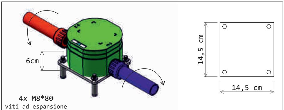
3 - controllare la scatola da incasso sia in bolla e correttamente orientata, in funzione della posizione di utilizzo scelta. Fissare la scatola da incasso con le viti in dotazione.
