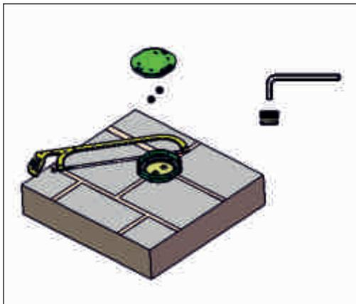
5 - collegare la colonna al supporto incassato disponendo correttamente i raccordi acqua calda / acqua fredda
